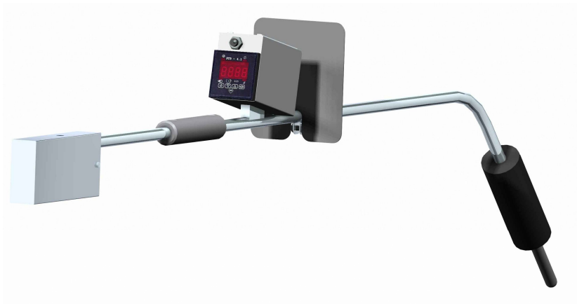
Рис.5 Термозонд с вольфрамрениевой термопарой для кратковременного измерения температуры в расплаве металла
